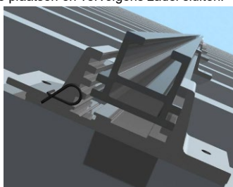
Figuur 46 Draagprofiel invoegen, op hoogte plaatsen en vervolgens zadel sluiten.
