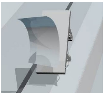
Figuur 43 Opplakken van de steeldeck klemmen Figuur 44 Verwijderen van de beschermende folie
